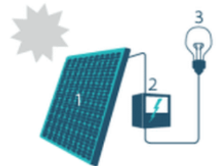
1. Zonnepaneel | 2. Omvormer | 3. Elektrische toestellen
